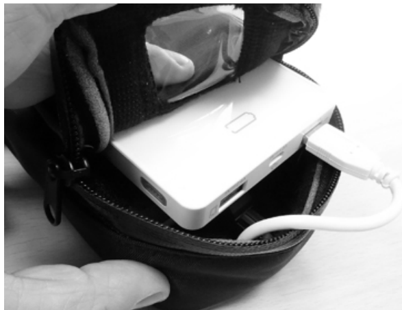
Figur 8: Udskiftning af batteri
